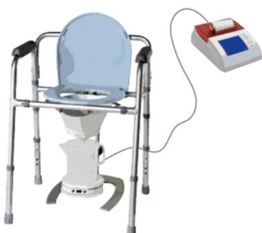
※便器下のセンサーが排尿のパターンを読み取り接続された、機器にデータが送られる。
